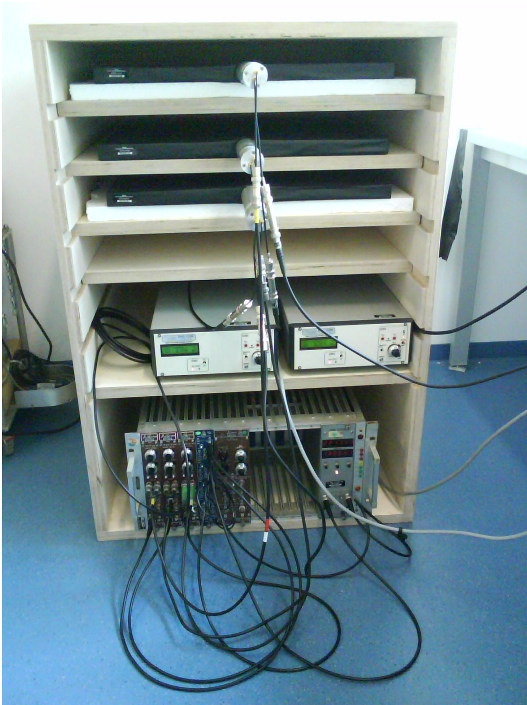
Abb. 3.3.: Messaufbau mit drei Szintillatoren. In der Mitte sind zwei der drei Hochspannungsquellen zu sehen, im unteren Teil ist die Elektronik untergebracht: links drei Diskriminatoren, daneben eine Koinzidenzeinheit und ein Time-to-Pulse-Height-Converter (der allerdings nicht verwendet wurde) und rechts ein Doppelzähler.
