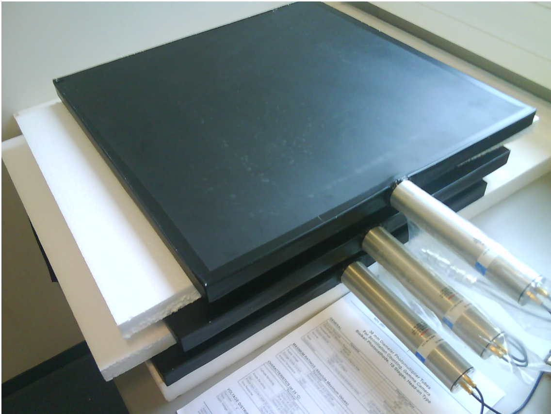
Abb. 3.6.: Die drei Detektoren, übereinander angeordnet. Der Durchmesser der PMT-Röhren ist etwas größer als die Plattendicke.
