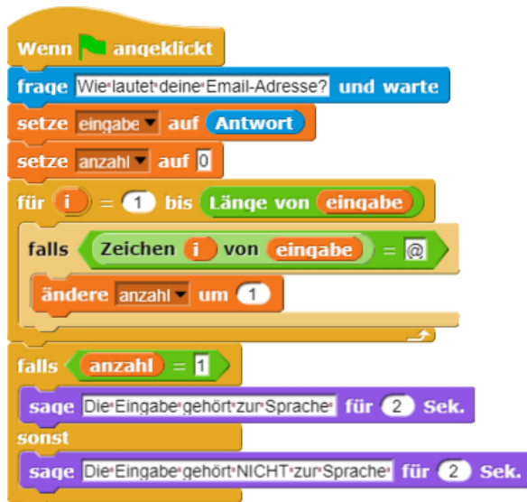
Abbildung 2: Die Sprache besteht aus allen Zeichenfolgen, die genau einmal das Zeichen @ enthalten.
