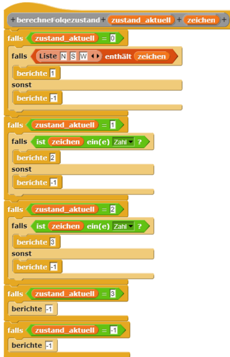
Abbildung 8: Implementierung zu Beispiel 2, dabei steht der Zustand -1 für einen Fehlerzustand
