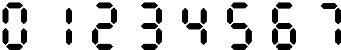
Abbildung 3: Darstellung der Ziffern 0 bis 7 in der Siebensegmentanzeige
